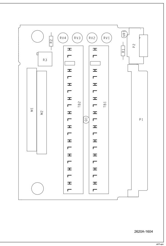
Figure 6-7. A4 Analog Input PCA
